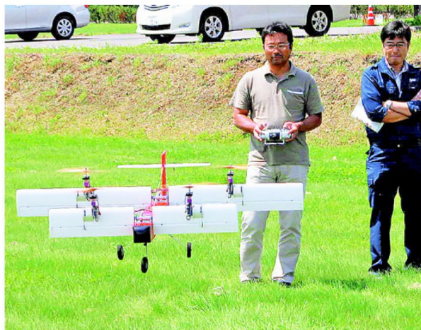
町多目的航空公園で垂直離着陸無人航空機の実験を行うJAXAスタッフ
