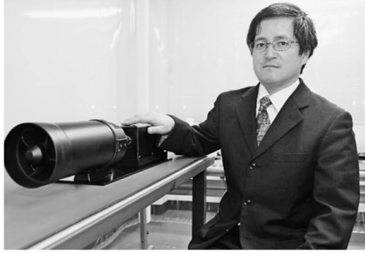
小型衛星搭載用のハイパスベクトルセンサと佐鳥准教授
