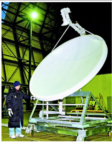
伝送実験に向け、送電システムの整備を進めるJAXAスタッフ
