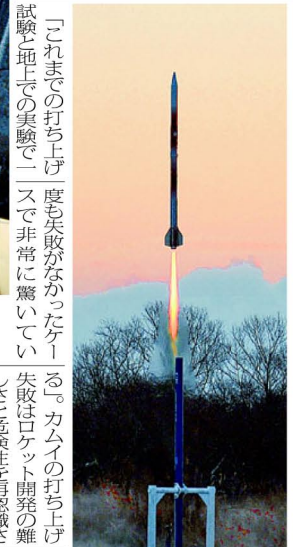
カムイロケット(プラスチック)と液体酸化剤を組み合わせたロケットエンジンで無火薬式で飛ばす。低価格で安全な小型ハイブリッドロケットとして、永田晴紀北大大学院教授が理事を務めるHASTICが開発。機体は再利用可能で、従来の小型固体ロケットと比較して打ち上げ単価を10%以下に抑えられるという。成層圏のオゾン層観測など気象観測用として期待されている。
