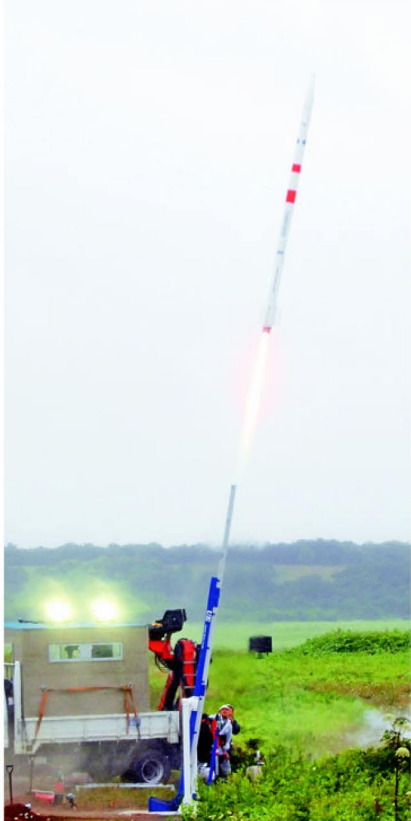
高度3.5キロまで上がり、地上からの信号で切り離しに成功したCAMUIロケット(4日前7時35分ごろ、塩原真撮影)
