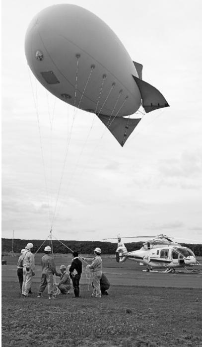
**[大樹]**独立行政法人宇宙航空研究開発機構(JAXA、本部東京)は、町多目的航空公園で地上200㍍の係留気球にマイクをつけて、ヘリコプターの騒音を計測する実験を行っている。周囲が静かで広大なスペースがある同公園ならではの実験。JAXAによると、気球を使った実験は国内では初の試みだという。
