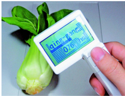
葉もの野菜の鮮度を数値で表示する小型測定機「鮮度アシスト」
