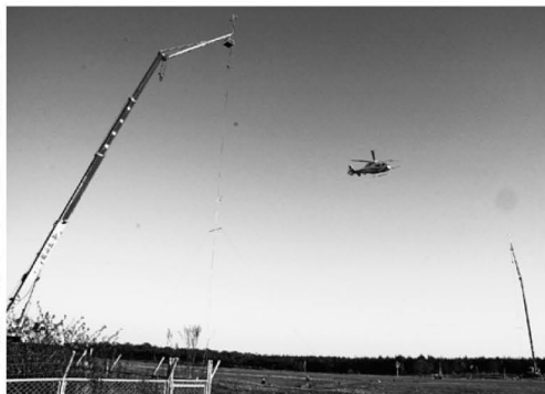
騒音測定実験で2基のクレーンの間を飛行するヘリコプター
