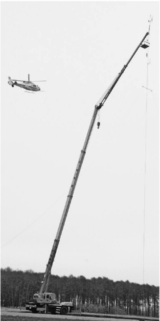
クレーンでつるされたマイクの周辺を滑空する実験用ヘリコプター
