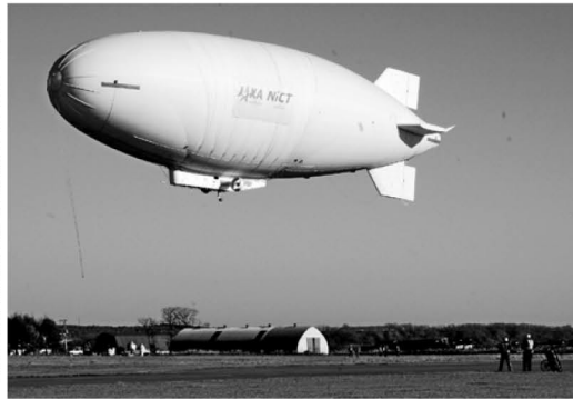
初めて空4キロでの通信放送試験などを行った実験用飛行船
