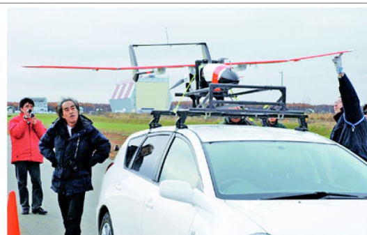
乗用車の屋根に取り付けられた小型無人機
