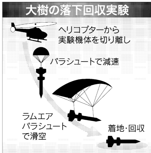
IHIエアロスペースが昨年行ったロケット型機体のつり下げ実験。今年は落下と回収に取り組む
